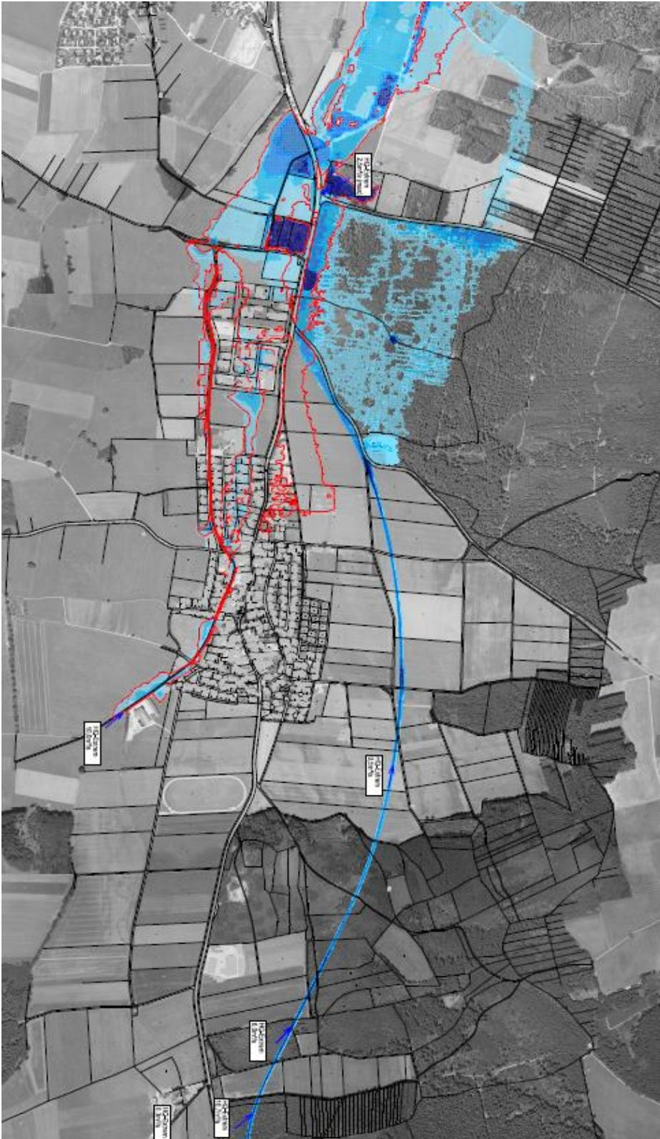
**Abbildung 5: HQ-Extrem Überschwemmungssituation im Plan-Zustand.**
